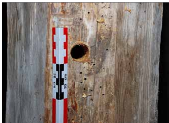
Otwór po pobraniu próbki do badań dendrochronologicznych
