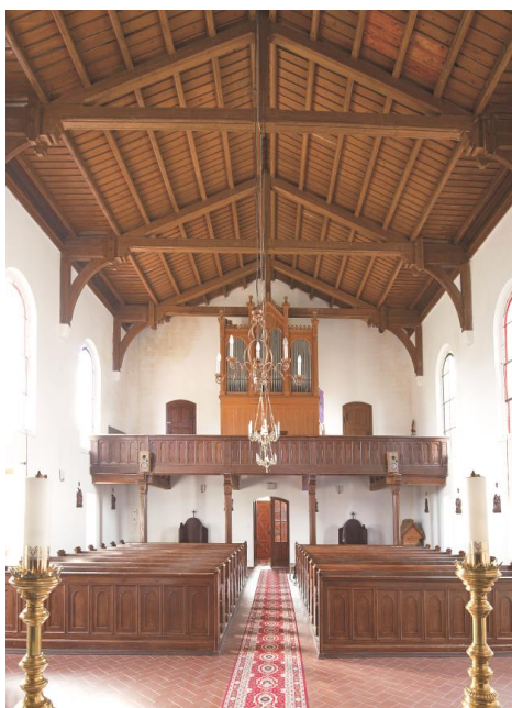
Ryc. 13. Więźba częściowo otwarta z pułapem dwuspadowym i nadwieszeniem poziomym. /fot. autor/
