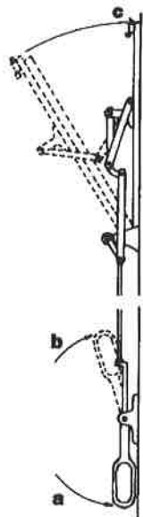
zamykacz; a - pozycja ręczki przy oknie zamkniętym, b - przy oknie otwartym, c - zatrzask
